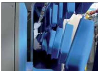
I prodotti in lega di alluminio ALUPRES ricevono trattamenti superficiali a forno che ne migliorano ulteriormente le caratteristiche di resistenza ad urti (30J) ed agenti chimici.
